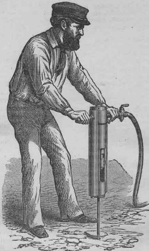
PERFORADORA WARSOP, TRABAJANDO VERTICALMENTE.
